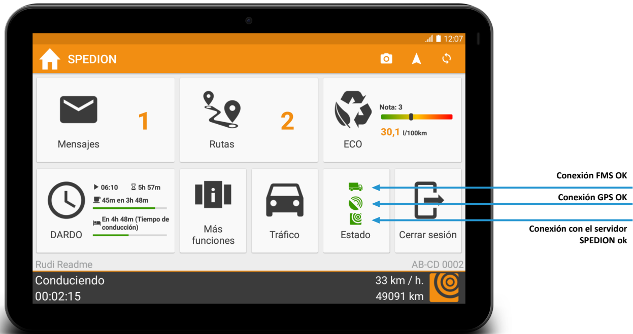
Fig. 21: Estado de las conexiones OK
