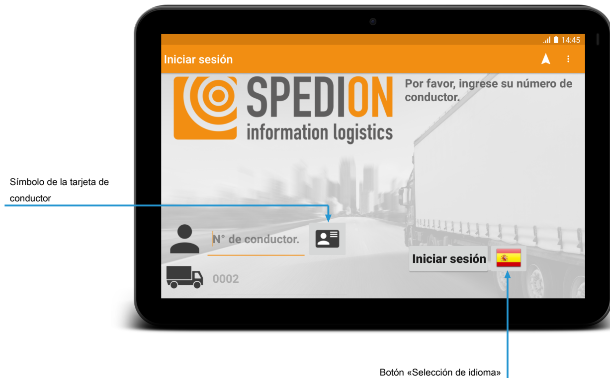
Fig. 8: Inicio de sesión automático con tarjeta de conductor para instalación fija
